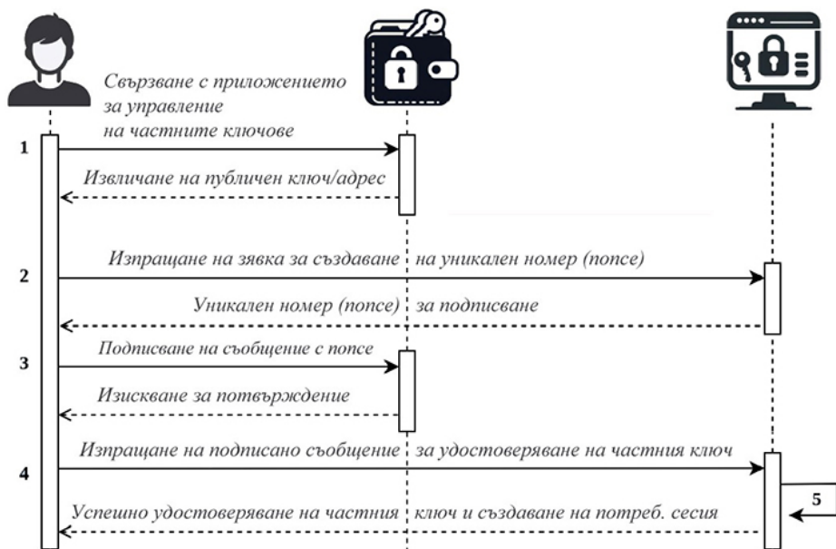
Фигура 1. Процес на удостоверяване чрез частен ключ
