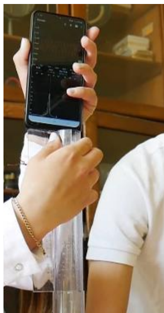
Фигура 6. Регистриране на връх на вълната с виртуален осцилоскоп
