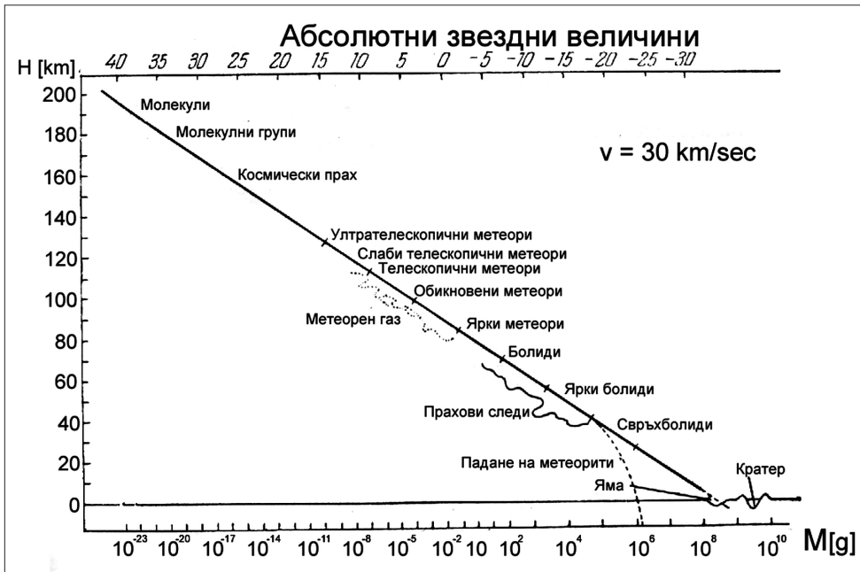
Фигура 4. Скала на мащаба на метеорните явления и зоната на задръжка (където метеорните тела изчерпват масата си или постигат скорост на свободно падащо тяло в съпротивителна среда) при зададена скорост от 30 km/s (Astapovich 1958)
