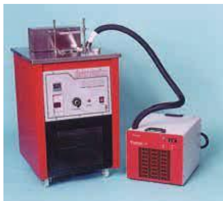
(б) Принципна схема на свързване между водния термостат и охладителното тяло 1)
