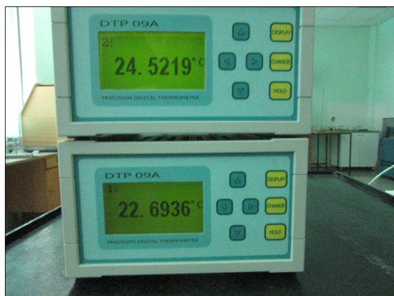
Фигура 5. Експериментална установка. Електронни дисплеи на съпротивителните преобразуватели тип DTP09A Precision Digital Thermometer
