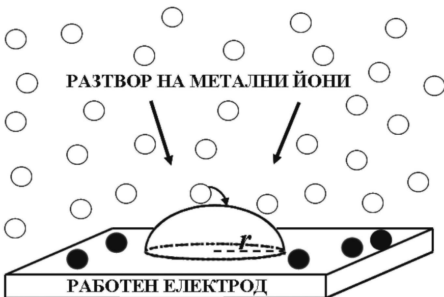
Фиг. 8 Сферичен зародиш на новата фаза с радиус r , нарастващ чрез директно вграждане на метални атоми в кристалната повърхност
